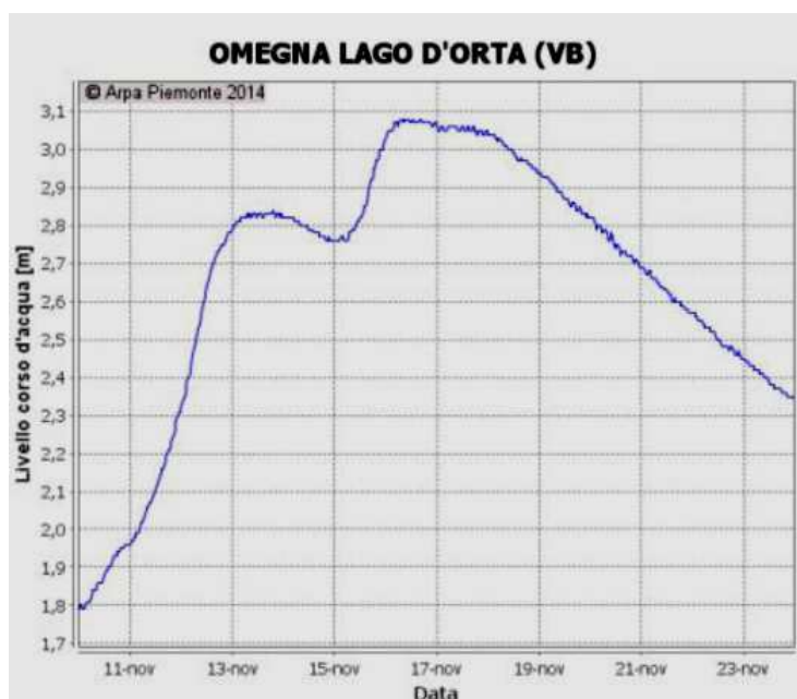
Idrogramma del lago d'Orta nel periodo 11 novembre - 13 novembre 2014 a Omegna (VB). Fonte: ARPA Piemonte
