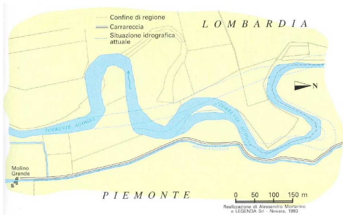
Fig. 32– Il Torrente Agogna prima del “raddrizzamento” effettuato a metà degli anni’ 50 del secolo scorso allo scopo di eliminare piene e straripamenti
