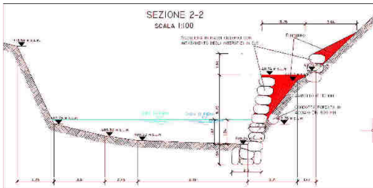
Figura n°23: sezione 2-2 torrente Pescone a valle dell'opera di presa
