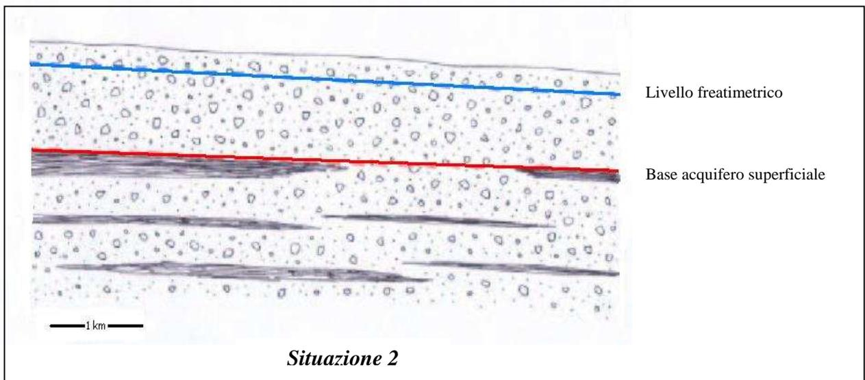
In corrispondenza dell'interruzione il limite inferiore del sistema degli acquiferi superficiali può essere interpolato per continuità con l'andamento del limite stesso nei tratti adiacenti della sezione (generalmente se l'interruzione non supera i 2-3 chilometri).
