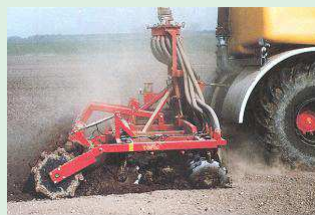
Spandiliquame collegato con erpice a dischi
